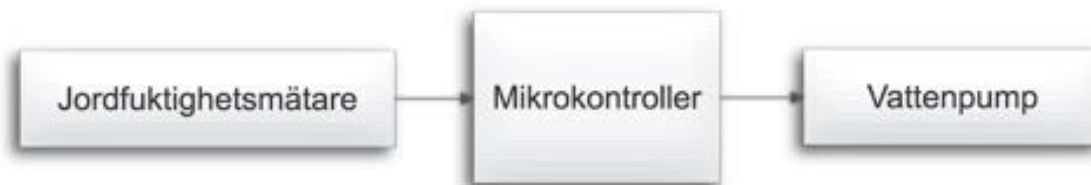
Figur 1: Teoretisk modell av enklast möjliga system.
