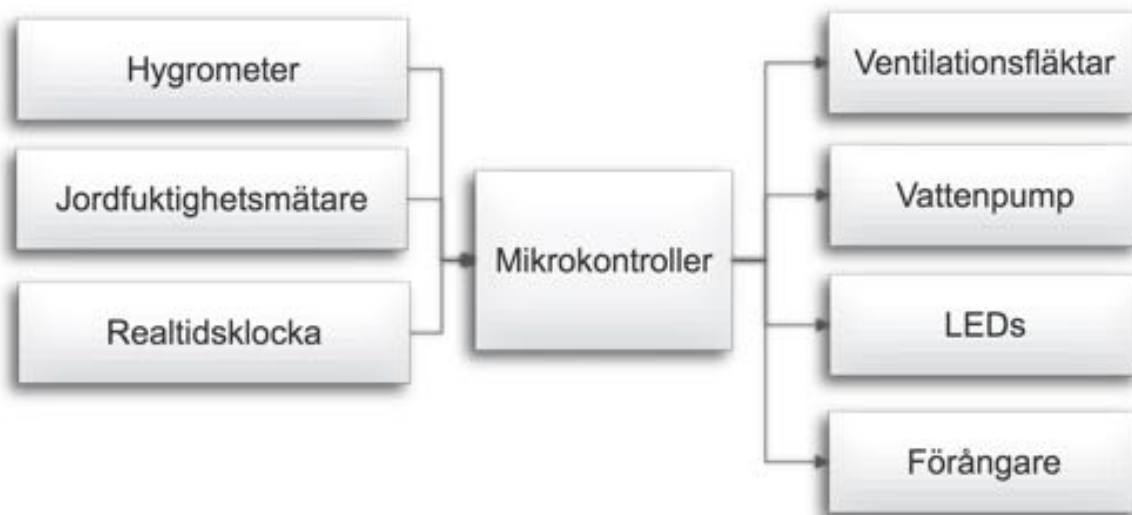
Figur 2: Teoretisk modell av det mer utvecklade systemet som önskas byggas i detta projekt.
